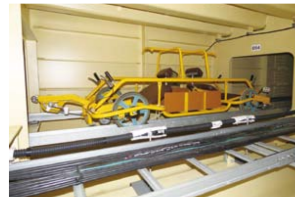
約400mの桁内を移動するための桁内移動車(鷹島肥前大橋)
