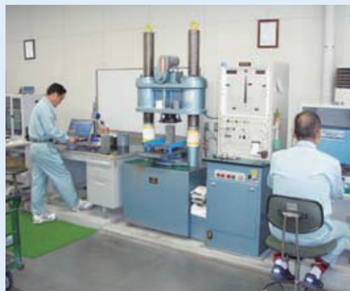
コンクリートの圧縮強度試験の様子
