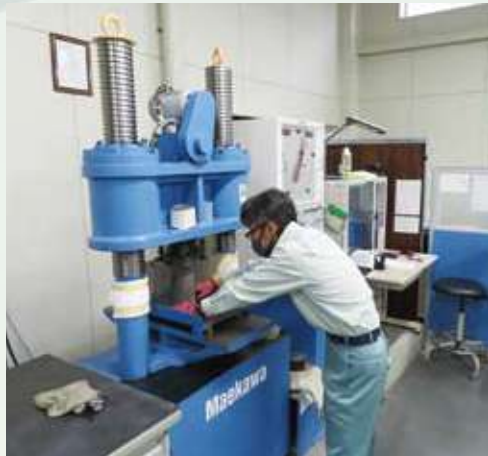
コンクリート圧縮強度試験
