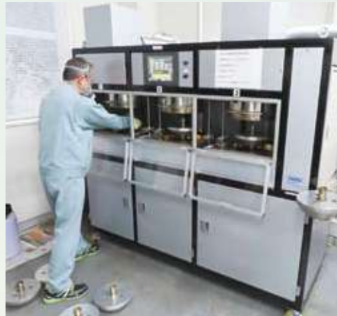
アスファルト抽出試験
