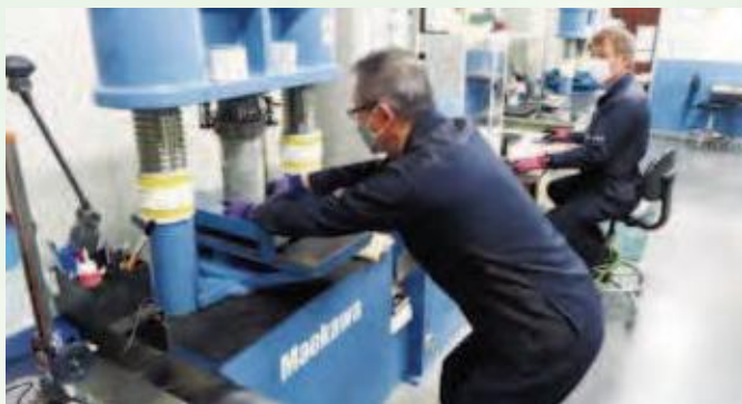
コンクリート圧縮強度試験
